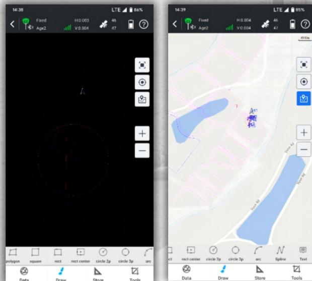
Selezionate i punti per formare un poligono e identificate direttamente i punti di divisione dell'area che il topografo dovrà sorvegliare. Non è più necessario che l'utente indovini una posizione da misurare e poi da regolare.
