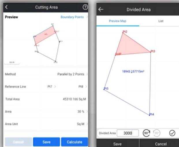
Selezionate i punti per formare un poligono e identificate direttamente i punti di divisione dell'area che il topografo dovrà tracciare. Non è più necessario che l'utente indovini la posizione da misurare e poi la corregga.
