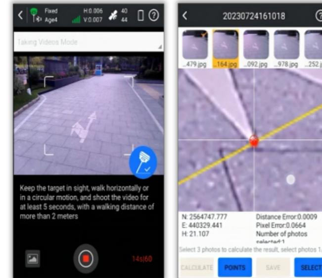
Le misurazioni di fotogrammetria possono essere eseguite scattando foto o video. È possibile acquisire le coordinate di tutti i punti delle foto.
